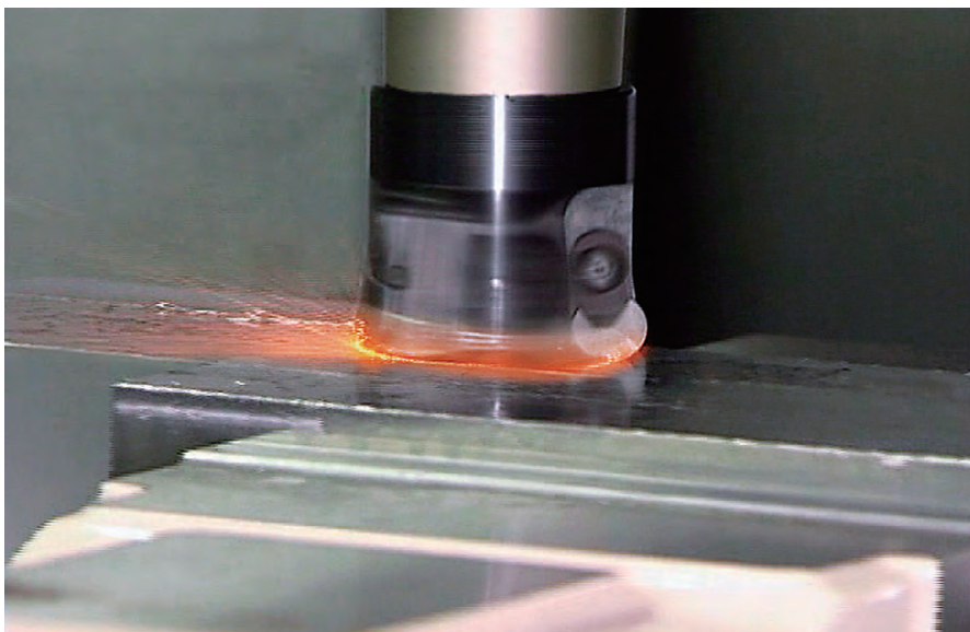
图 1 用惯了陶瓷刀具的机械师怎么会害怕切割区喷出的火焰呢？热量并不会构成任何威胁。相反，这些刀具需要热量
