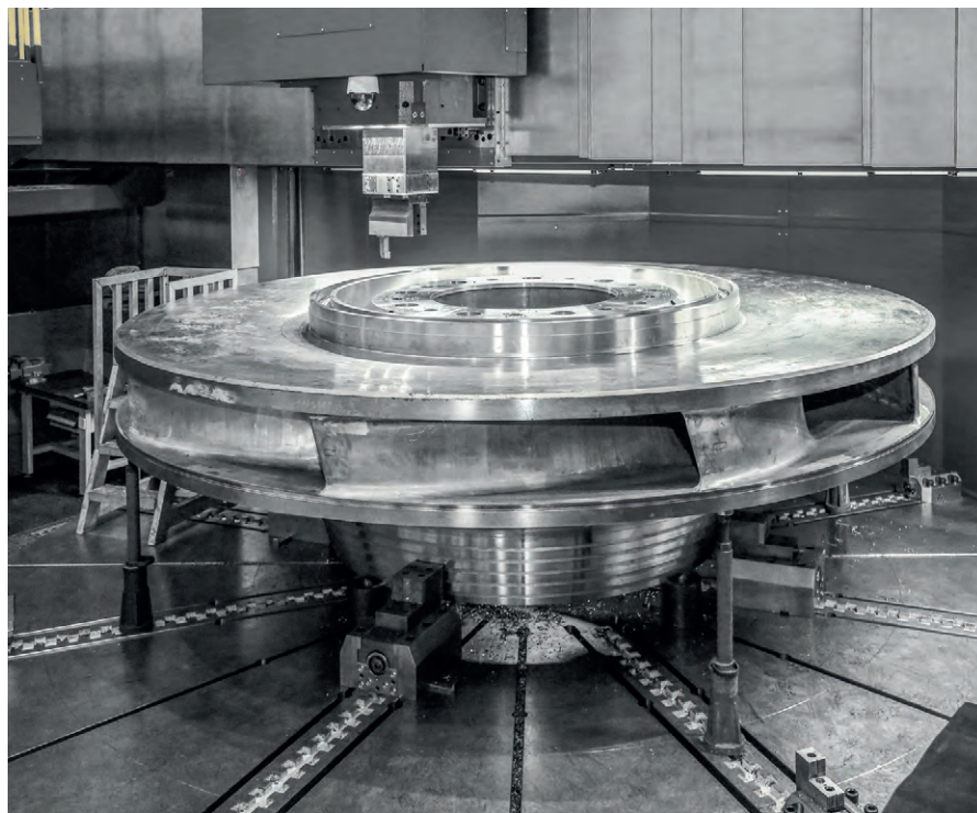
图 2 原先需要两台机床的水轮机转子，现在可以在一台多利斯 VC 6500/600 MC 上完成全部加工“加工周期缩减了 20% 以上，既降低了劳动强度，加工精度也得到了提高。”
