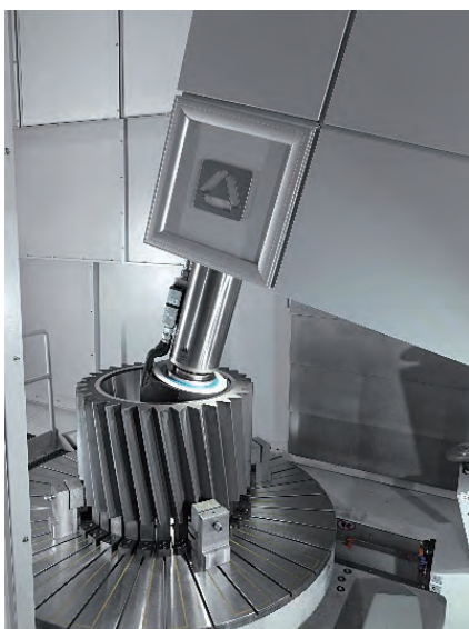
图 1 为确保在更短生产时间内提高生产率，定制化的达诺巴特 VG 立式磨床可适应多种应用需求
