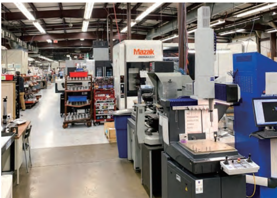
图 1 PMSI 当前拥有五轴铣床、标准铣床、11 轴 Mazak Integrex 机床以及双主轴双转塔车床。车间同时还拥有 3 台 DMG MORI NMV 3000，配有 320 个工具转盘，可处理 32 至 115 个托盘。该车间员有 70 名员工，包括 36 名机械师和 6 名过程工程师，负责加工过程开发和编程
