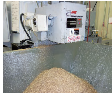
图 2 编程加上切削工具提高了无人值守生产模式的可靠性, 产生的碎渣很小很细。负责人认为牺牲切割速度换来更低的重新切割风险, 避免系统在无人值守模式下提前发生故障是值得的
