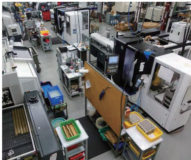
图 1 无人值守生产模式始于设备, 却不会止于设备。图中是棒料进给数控车床 (左边) 和棒料进给五轴机加工中心 (右边)
