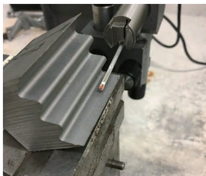
图5(a)表面光洁度测量方向(平行于磨削方向)
