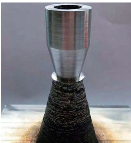
图中所示喷嘴显示了混合制造系统如何通过增材和材料加工来满足规范要求
