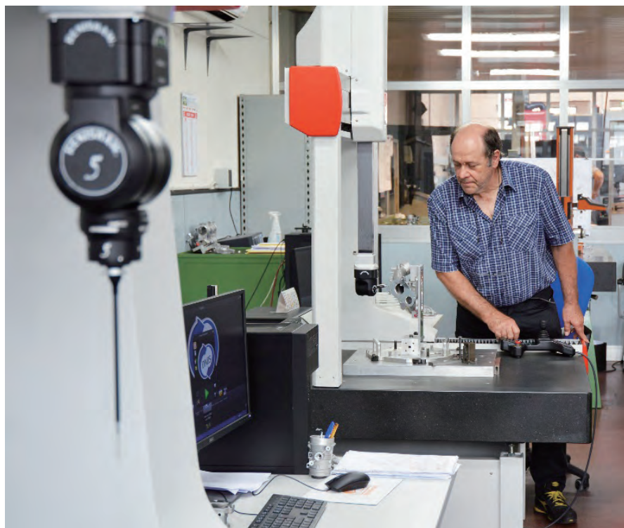
图 3 针对某些特定的零件，R.Busi 使用的是雷尼绍的 REVO 五轴测量系统执行测量
