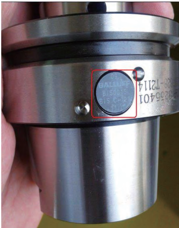
图 1 用于数据管理的电子传感器
