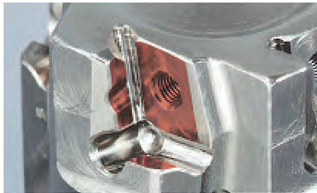
图 1 刀片三个定位安装面
