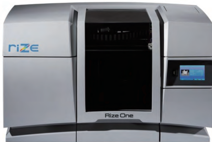
图 1 IGI 使用 Rize One 3D 打印机进行仿造和原型制作。该系统使用了 Rize 的增强沉积技术。所谓增强沉积技术，包括挤压和喷射。机器向层与层之间的缝隙喷射脱模剂，干净利落地去除支撑结构。喷射技术还利用了 IGI 自带的油墨标记功能，将工作订单号、流水线号以及各个部件的图片印在固定装置上，方便识别，此外还可以印上使用和存储说明
