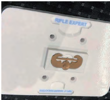
图2 Ira Green Inc. 公司主要生产各类军装装备, 例如奖章和别针。3D 打印的固定装置可确保钉子位置的准确性, 同时显著降低了设计和建造固定装置的时间和成本, 该机器还自带油墨标记功能, 通过 3 点验证法防止出错 (图片来自 Ira Green 公司)
