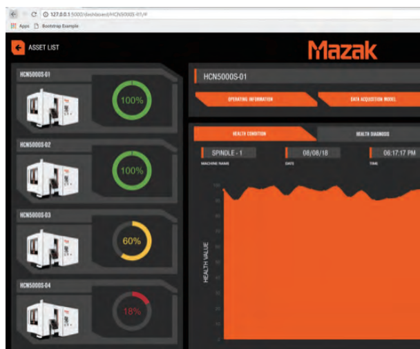
图2 用户可以调用60s主轴健康监控系统(SHMS)测试功能确定某一机床主轴的剩余寿命百分比
