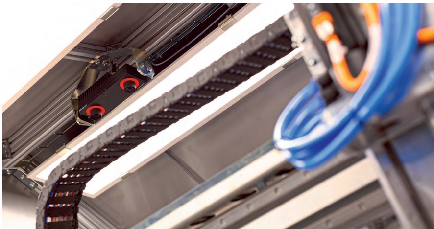
图 1 分拣机器人的核心元素是两个 3D 立体传感器 rc Visard 160，它们是感知的重要组件
