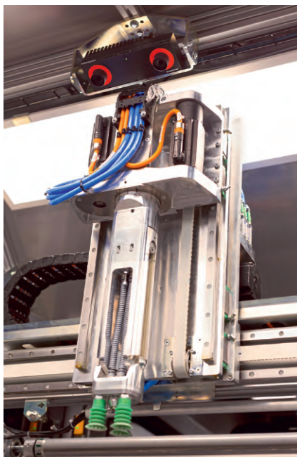
图2 3D 立体传感器支持系统以 3D 方式实时了解和分析环境并规划和实施抓取过程
