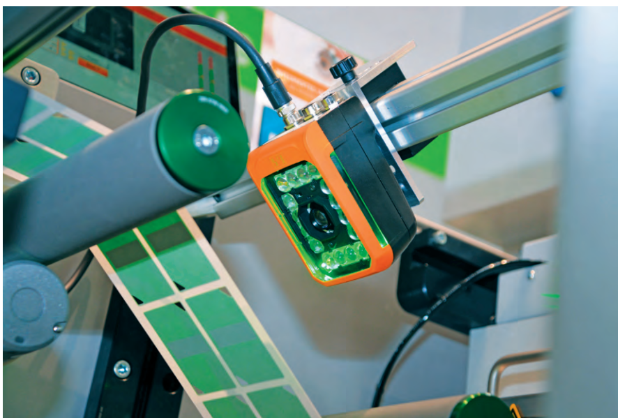
图 1 Spilker 公司使用的贝加莱智能传感器可以实时提供每个标签的位置值，然后用于控制系统的模切机
