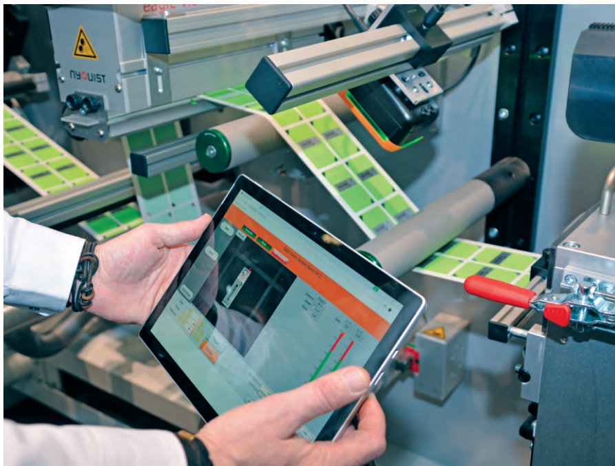
图2 借助 HTML 5 和 mapp 技术，Spilker 能够为用户提供在智能手机或平板电脑上进行传统的 HMI 操作和基于 Web 操作
