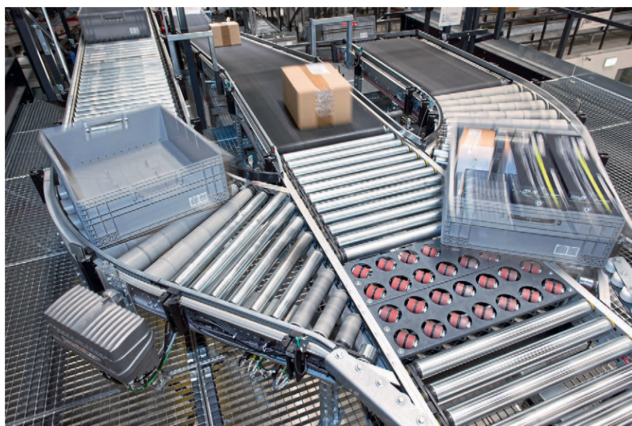
图 2 PSB 公司研发的高性能周转箱输送系统每小时的物资吞吐量为 3000 周转箱
