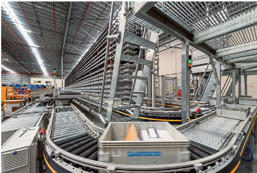
图 5 Dematic 公司提供了一种全集成式通用物资输送系统；其不同的标准化模块可以按照用户的实际要求配置成不同的输送系统
