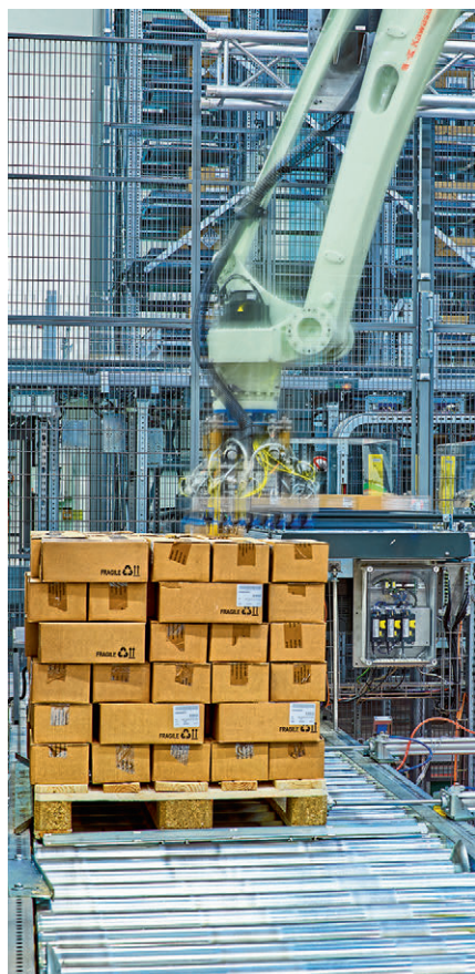
图 6 辊道和链式输送机组成的 Powerline 托盘输送系统可运送总重量 1300 kg 的单托盘物资
