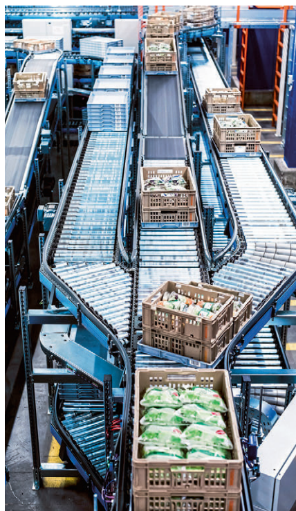
图 4 Streamline 输送技术系统是专门为周转箱、纸箱、包装标准和软包装物的运输而设计的
