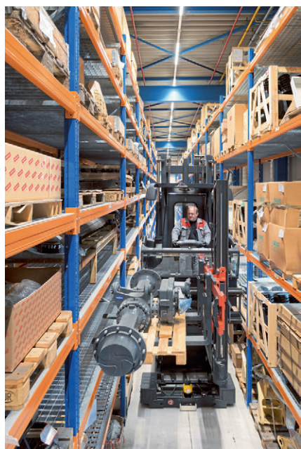
图 2 为了避免 Linde K 窄道叉车与屋顶下的横梁发生碰撞，所有窄道叉车都配备了 Linde 公司的叉车行驶安全助手
