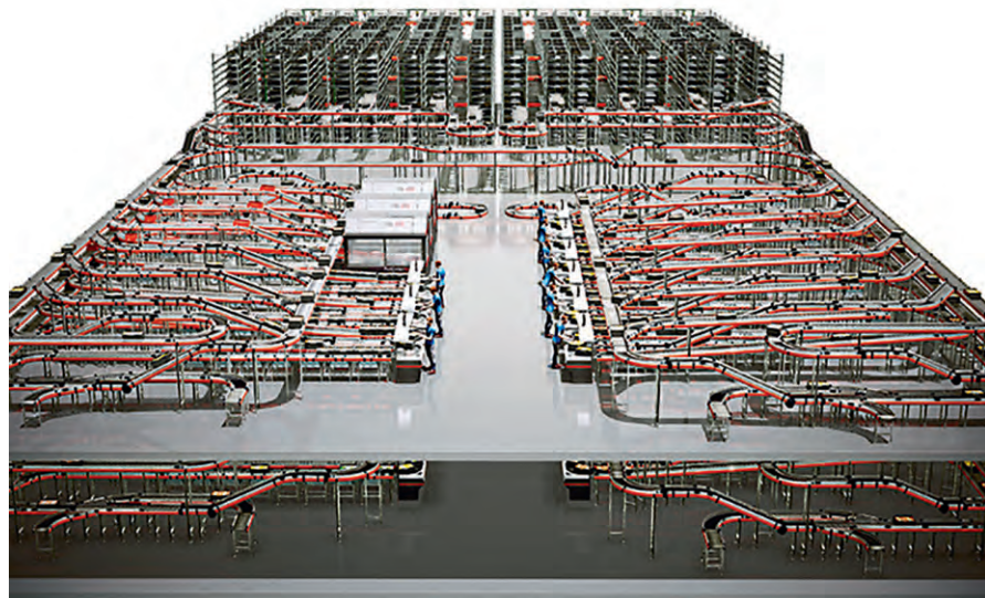
图 3 TGW 公司开发的货到人处拣选配货解决方案可将不同的销售渠道（电子商务、批发和零售）结合到一起
