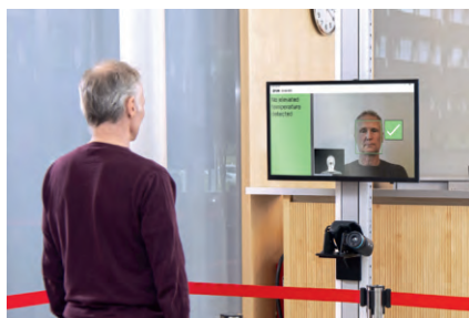
图 2 Flir-Screen-EST 软件改善了新冠疫情体表温度的检查过程
