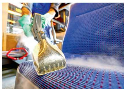
图 4 公交车上的杀菌消毒：Beam 公司蒸汽抽吸系统还可以净化室内空气
