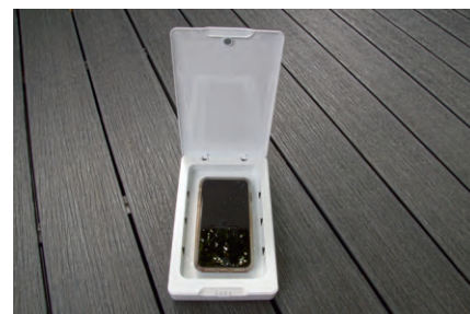
图 3 “紫外线消毒器”可以在大约 5 min 的消毒时间内杀灭多达 99.99% 的常见表面细菌
