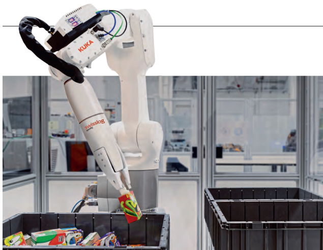
图2 Swisslog 的 Item Piq 产品构建了在机器人技术中应用人工智能的基础：智能视觉系统能够识别未知物品的抓取点，选择正确的抓取方法，从而使学习过程更加轻松
