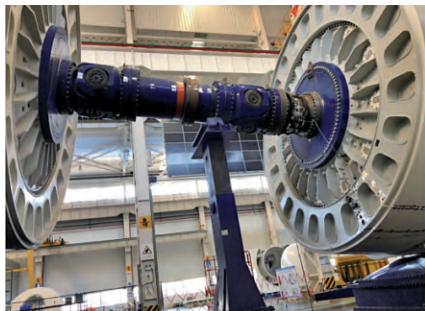
图 1 通过编码器对电机转速进行检测，以测试发电机在每个转速段的发电状况
