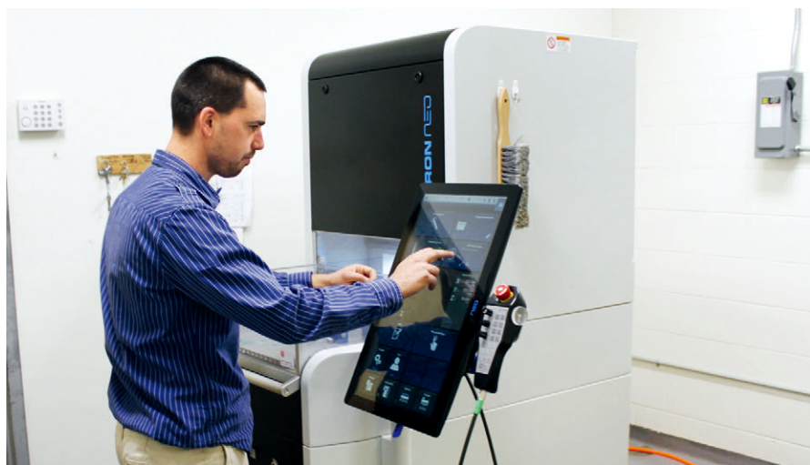
图 2 设计师 Marc Fournier 正在使用 Neo 的触屏界面进行铝模具设置。对于没有一点加工经验的他而言，Neo 的光学部件定位系统起到了很大的作用。他只需要动动手指，放置部件，然后由控制系统进行调整，就可以完成加工了
