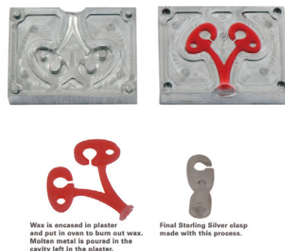
图 3 以上是 R&D Manufacturing 公司经常用于珠宝部件制作的铸模工艺示例。在制作图中所示的这款手镯扣环时，需先使用 Datron Neo 进行铝材铣削。模具内填满蜡后用石膏盖上，然后放在烤炉中将蜡融化，然后石膏变硬，形成空腔。再将熔化后的金属倒入空腔内，形成扣环
