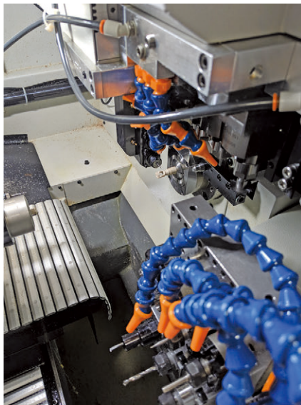
图 2 为了加工图中所示 PEEK 医疗部件，Challenge Machine 公司购买了第一台带旋转 B 轴的瑞士机床，加工这样一个零件只需 15 min，而如果换成五轴或三轴铣床，则需要一个小时
