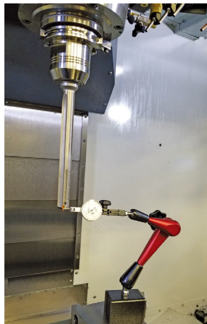
图 2 在机器上安装指示器，用于测量钻入深度和偏摆角度，避免出现误差
