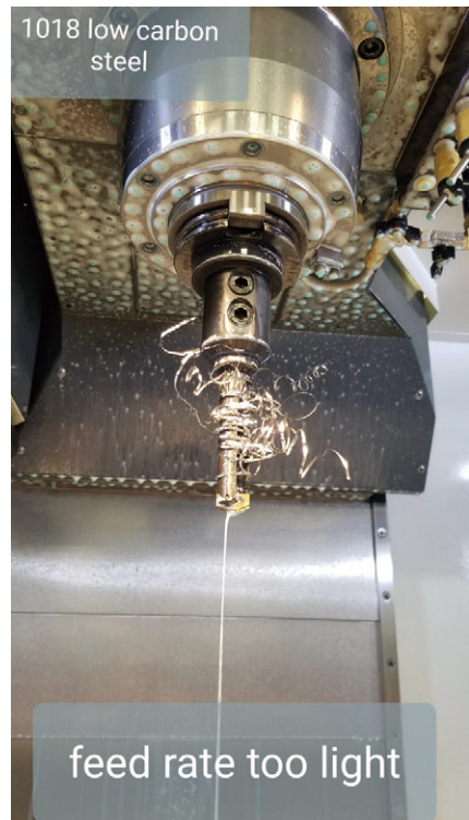
图 4 鸟巢式布局可以避免钻头进给时过于强势。图中所示为该钻头用于 1018 低碳钢的情况
