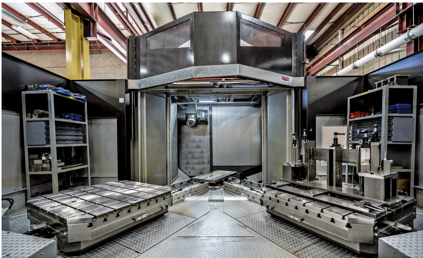
图 1 FH1250SX-5 轴卧式加工中心搭配的主轴转速高达 15 000rpm、转矩高达 400 Nm，加工产生的热量低，可以用于加工从铝到钛的各种材料
