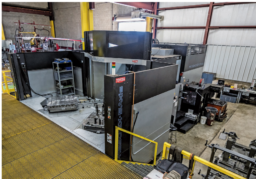
图 3 FH1250SX-5 轴卧式加工中心的大规模加工性能降低了 Metalcraft 公司对专用刀具的依赖，同时提高了刀具寿命，包括用于硬质金属的大型机器上的刀具
