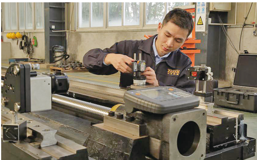
图 1 厦门大金最先选用雷尼绍 XK10 激光校准仪
