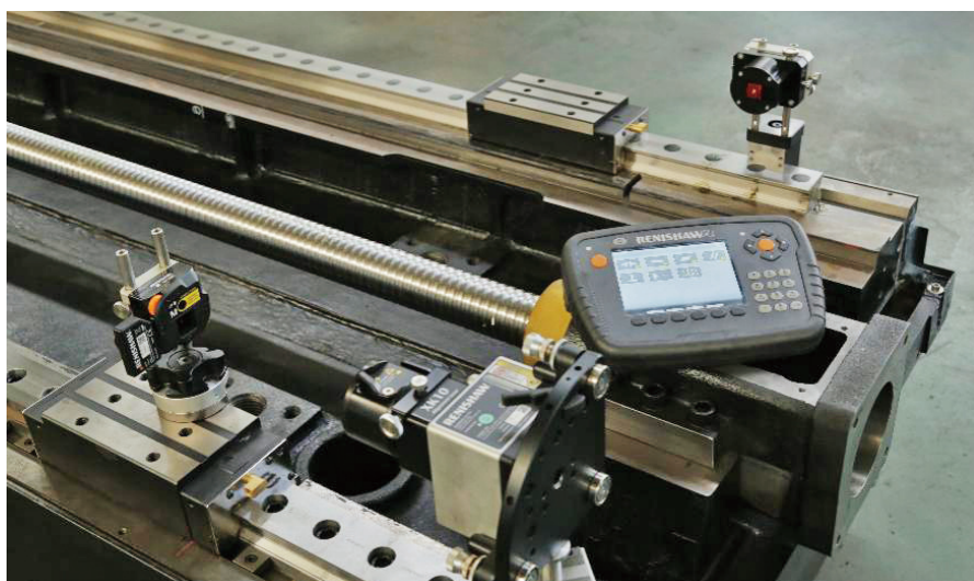
图 3 目前大金集团大部分的机型在组装时都有用到 XK10 校准仪和记录
