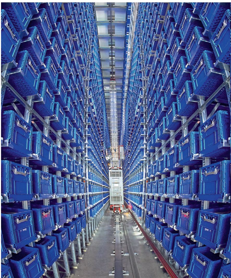
图 1 AKL 自动化小件仓库中的周转箱提供了很高的物资存储容量，可以方便快捷地存取物资，有着很高的出入库吞吐量
