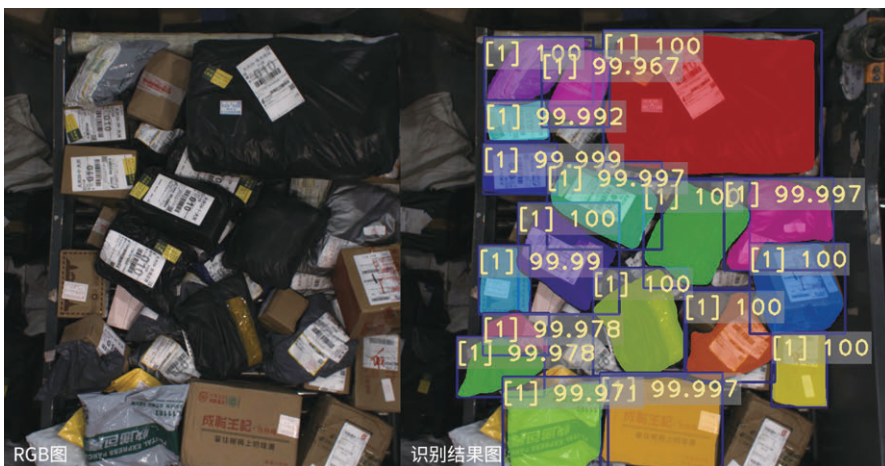
图2 高精度 3D 智能相机可准确识别货筐中的海量不同货品和随意堆叠的快递包裹
