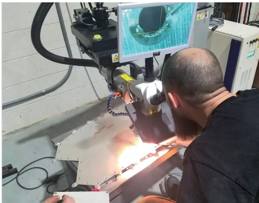
图 2 CMS 公司的一名员工正在使用 LaserStar 8700-3 系列光纤激光焊接工作站维修塑料注塑模具
