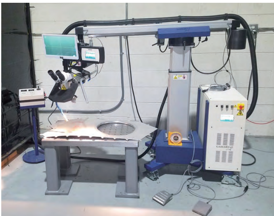
图 1 工作站增加了多项功能，包括塔架龙门，用于简化激光器移动到模具旁的过程，此外还增加了一台电动工作台、一个摄像头和监控器，起到协助培训操作人员的效果
