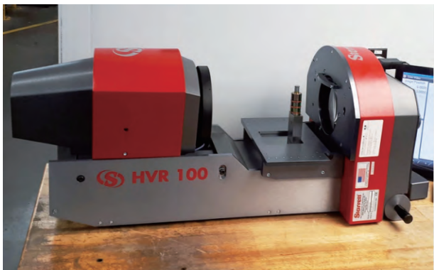
图 3 Flip 系统支持水平或垂直位置使用。图中可以看到，BCI 的设备放于一张桌子上，员工能够根据被测部件的尺寸和固定方法切换配置
