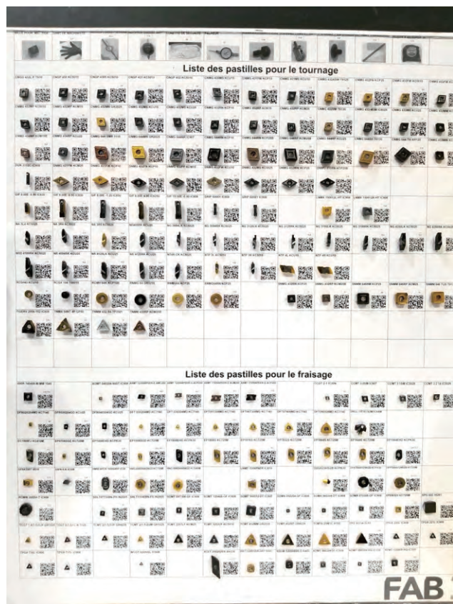
图 3 该面板显示了实际使用的镶刀和机械师可以扫描的二维码。扫描二维码后，切割数据将显示在计算机屏幕的左侧
