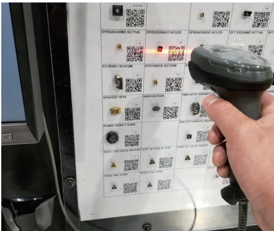
图 1 加拿大制造商 Fab3R 近期研发出了一款切割刀具数据站，目的是为工程师选择硬质合金镶刀、设定进给量和速度提供数据基础。工程师们仅需用扫码枪轻轻一扫，便可查看切割数据
