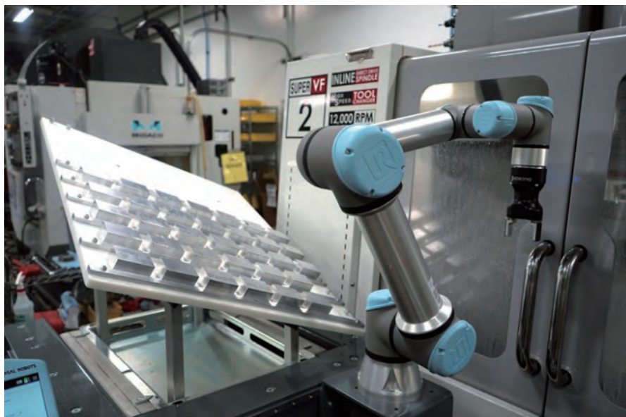
图 4 Fusion OEM 的定制部件嵌套系统，位于采用单个 Robotiq Hand-E 抓手的通用机器人 UR10e 旁边
