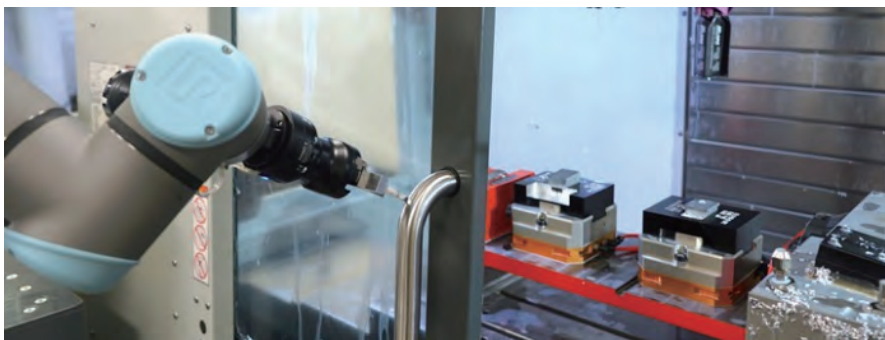
图2 通用机器人 UR10e 正在关闭加工中心的大门
