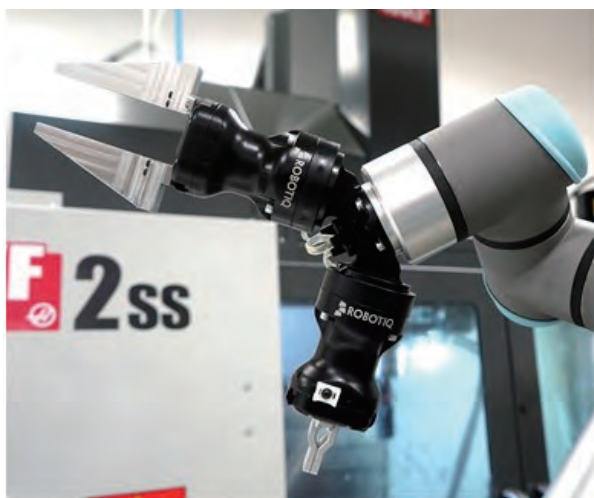
图 3 Fusion OEM 对其中一个抓手进行定制设计，只需几分钟便可安装到 Hand-E 的定制指尖滑块中
