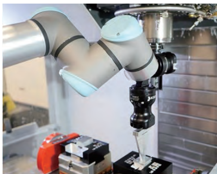
图1 由 Robotiq 公司生产并安装在 Fusion OEM 某台 CNC 机床 (共有 14 台) 正在将加工后的部件从一个虎钳转移到另一个虎钳
