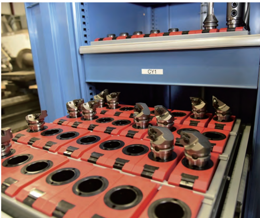
图 1 多年来, Anthony Machine 的车间一直在使用 Kennametal 的 KM 快速更换刀架。因此, 在为 DMG MORI 的新型 Y 轴机床配备快速更换刀具时, 他们自然而然想到了这家公司。这次的任务是配备 NLX 3000 的刀塔
