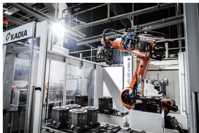
图 4 KADIA 去毛刺自动化单元内部一览。铸铁外壳装在托盘上，在加工中心进行双组加工
