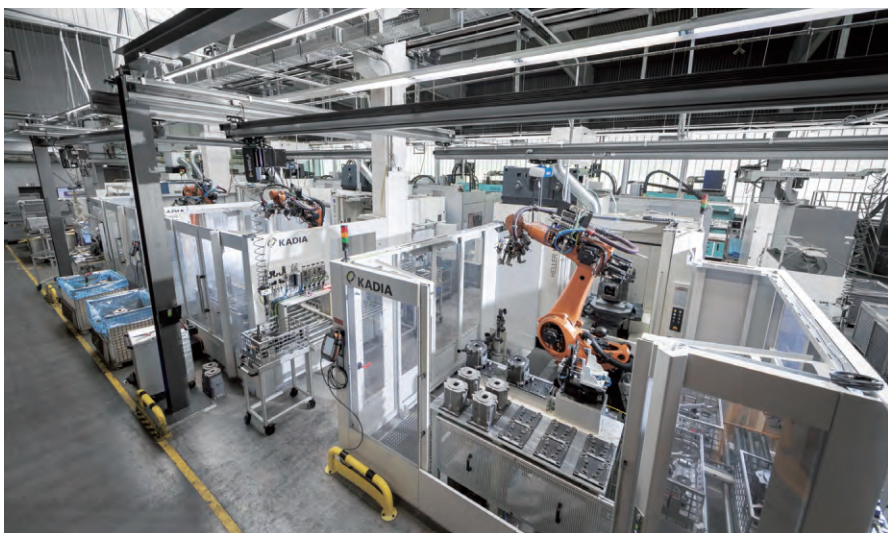
图 1 KADIA 的 RHDC 和 ZSO 加工中心一瞥。由于接口和周密的工艺设计，这两个工厂部分形成了一个完整的生产单元，并紧密合作
