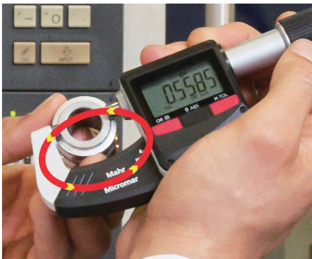
尽可能缩小测量回路可以确保最佳性能
