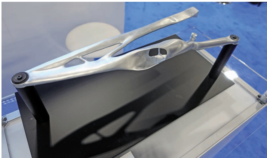
图 2 在一个五轴加工中心上生产 F1 型赛车的叉臂悬挂臂
