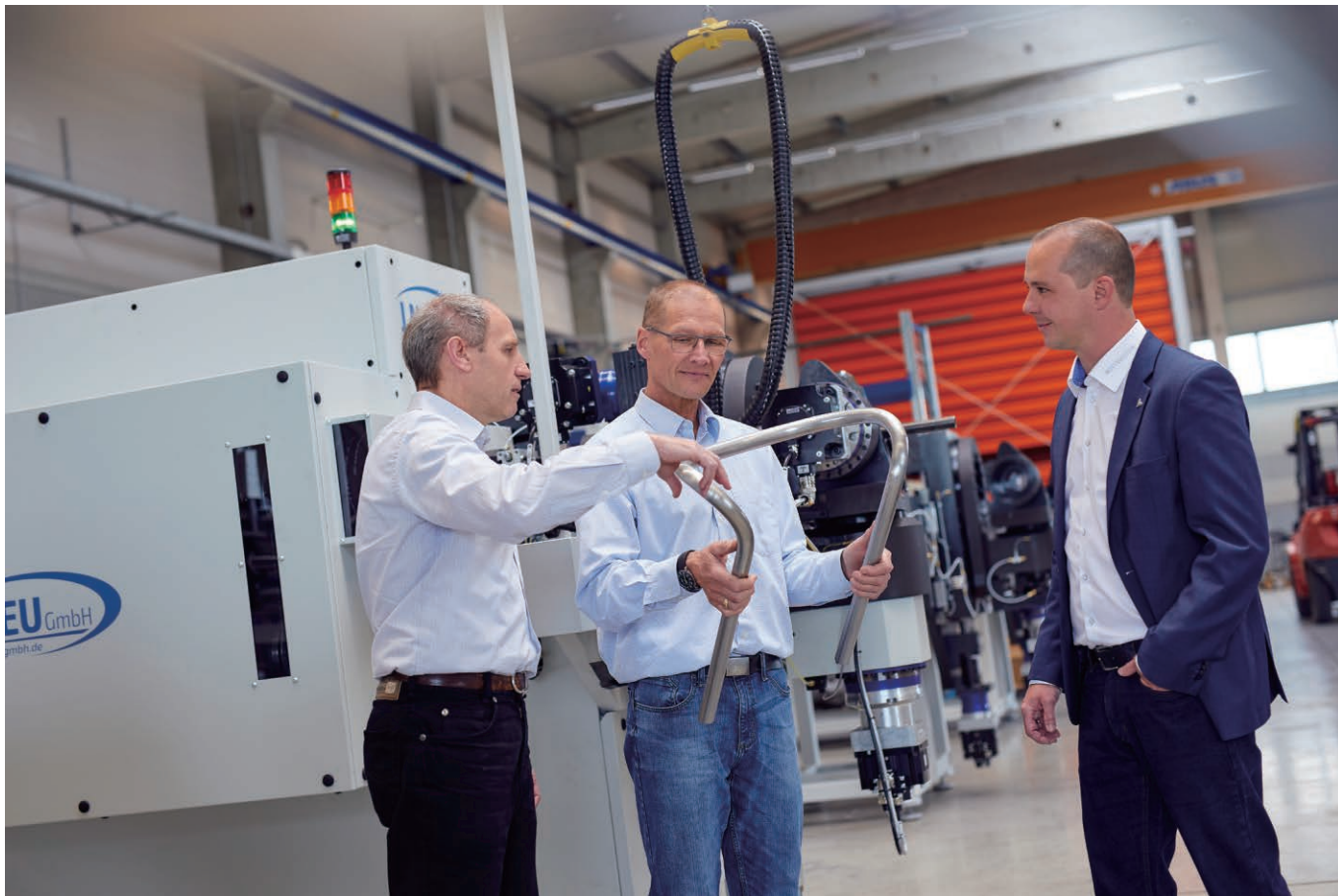
图1 J. Neu GmbH 公司凭借结合了极低的回程间隙、高扭转刚度和转矩密度的齿轮箱，保证了高重现性的弯曲形状和高可用性的工艺，以及高动态性能，最终缩短了弯管生产的循环时间
