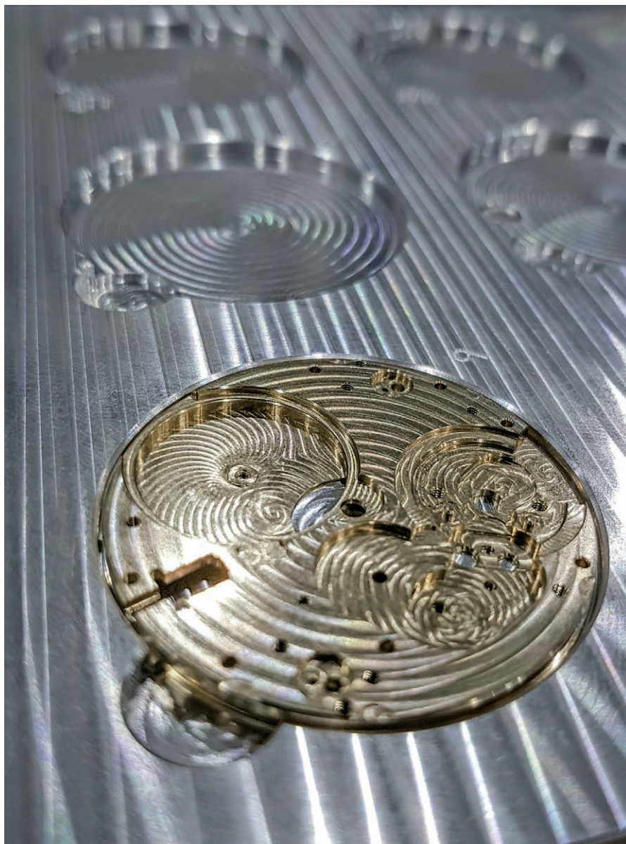
图 2 金字塔纳米型五轴加工中心可以加工亚微米精度的零件
