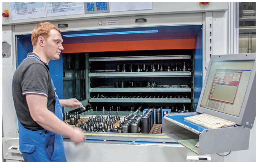
图 3 得益于刀具立体柜上的四个 TDM 工作站，可以快速将订单的各个组件组合在一起
