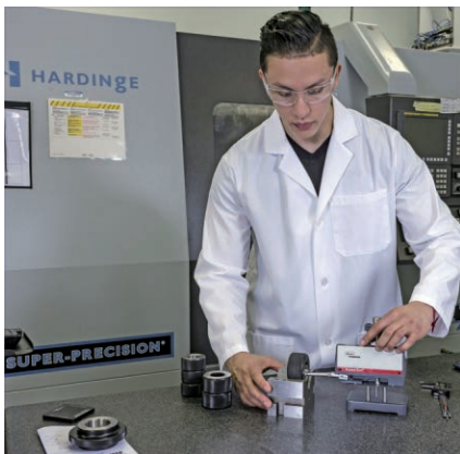
在制造时验证表面光洁度可以消除操作人员的影响
