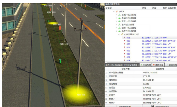
图8 配电线路三维可视化平台
