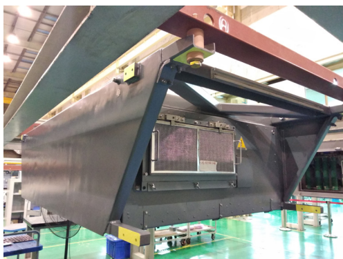
图10 动车组充电机产品样机照片 Fig. 10 Photo of prototype of EMU charger
