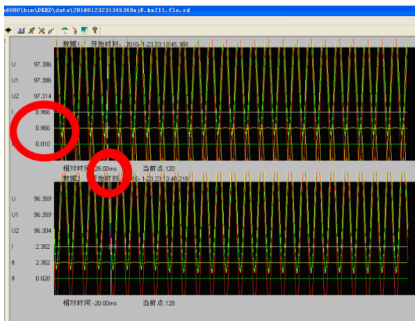
图2 211DL跳闸故障25 ms录波截图
