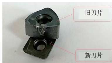
图1 改制前后刀片对比
