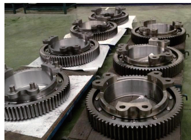
图9 从动齿轮置换配对修复
