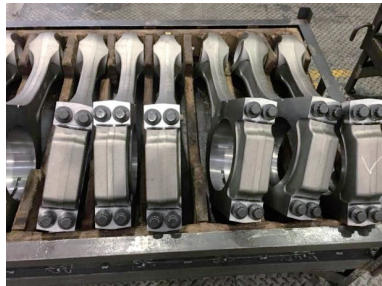
图7 已等级修复的连杆
