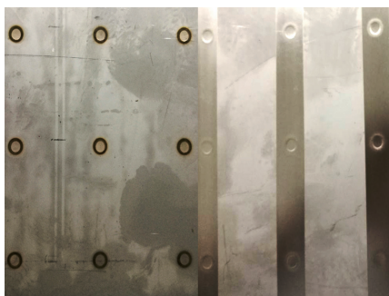
图5 激光清洗不锈钢电阻点焊氧化色
