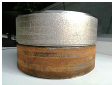
图9 激光清洗前后的集电环
