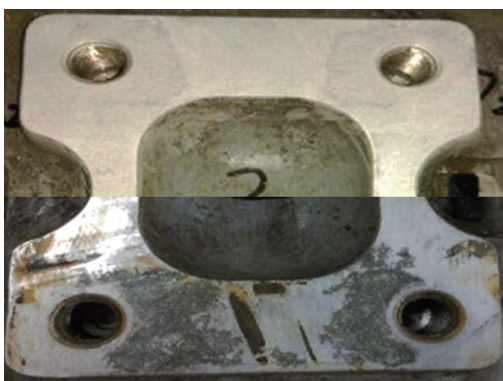
图11 激光清洗前后的轴箱体
