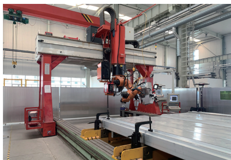
图2 铝合金激光清洗复合焊接全自动机器人
