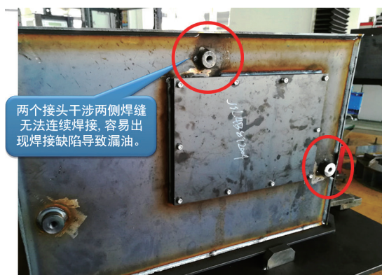
图3 油箱法兰接头与平板间距过小
