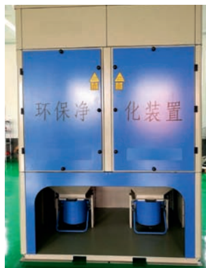
图2 拼装滤筒除尘器整体实物
