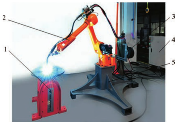
图3 焊接机器人系统
