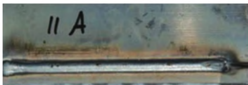
图7 PMC工艺焊接镀锌板
