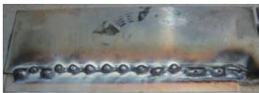
图6 普通的脉冲工艺焊接镀锌板
