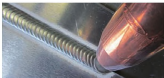
图9 PMC Mix Drive工艺焊缝成形
