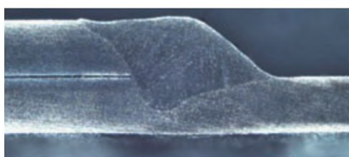
图8 PMC工艺焊接镀锌板焊缝的熔深
