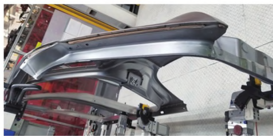
图14 白车身侧围落水槽的CMT Braze+钎焊
