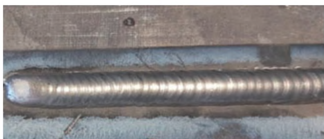
图13 3mm镁合金板（AZ31B）的搭接焊缝成形
